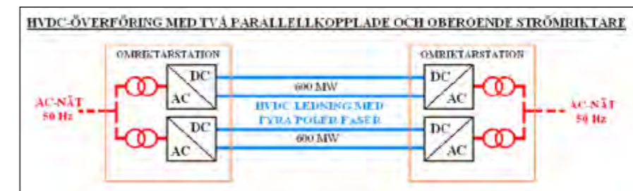
Figur 5.4 Överföring med två parallellkopplade strömriktarsystem. Detta system planeras i SydVästlänken.
