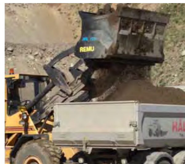
Figur 5.21 Utnyttjande av siktskopa vid arbetsplats respektive upplagsplats för massor (www.remu.se).
